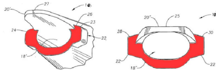
Abbildung 4: Fig. 3, 4 und 5 aus dem Streitpatent mit rot markierter «plane of opening» (ro
